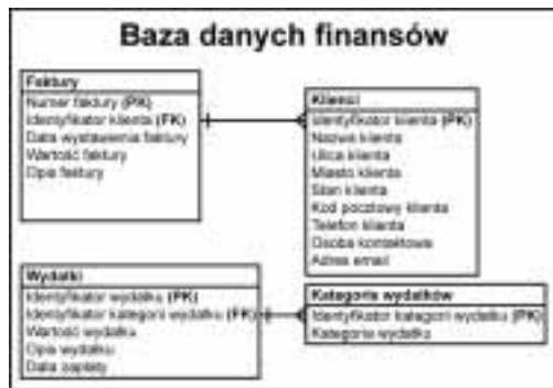
Rysunek 3.9. Prawidłowe umiejscowienie danych – pola: osoba kontaktowa i adres e-mail wymaga przeniesienia ich do tabeli Klienci
