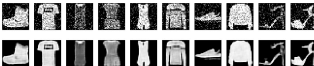
Rysunek 11.3. Zaszumione przykłady (na górze); przykłady odzsumione (na dole)
