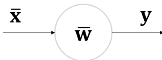
Rysunek 6.1. Ogólny schemat neuronu hebbowskiego z wejściem w postaci wektorowej
