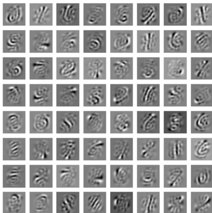
Rysunek 5.8. Składowe niezależne zestawu danych MNIST wydobyte za pomocą algorytmu FastICA (64 składowe)
