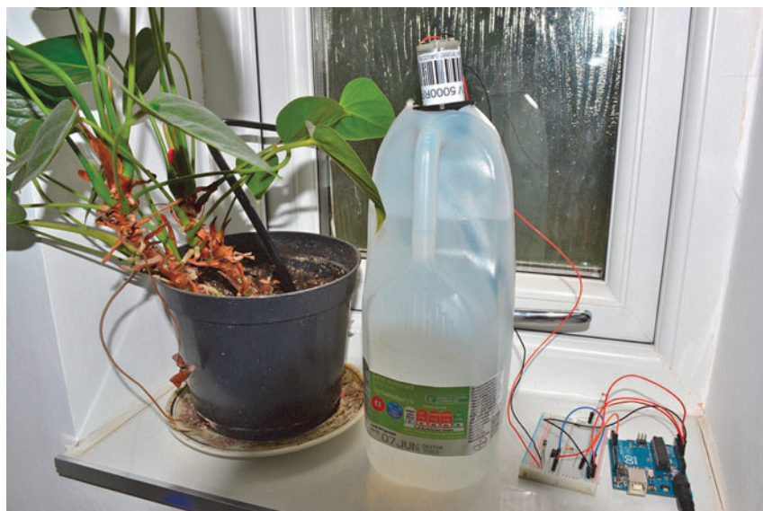
Rysunek 7.16. Urządzenie podlewające domowe kwiaty
