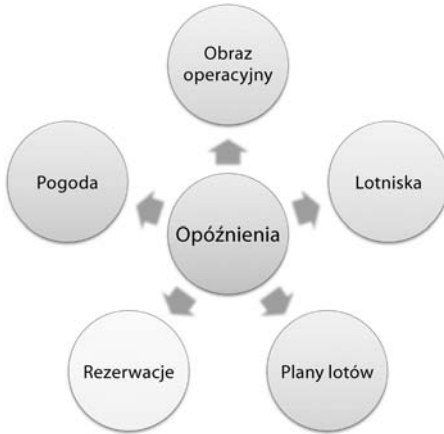
Rysunek 5.9. Niektóre z usług, z którymi musiałaby współpracować usługa „Opóźnienia”. Usługa „Opóźnienia” steruje kilkoma usługami bezpośrednio (takimi jak „Rezerwacje” i „Plany lotów”), ale sama jest sterowana danymi pochodzącymi z pozostałych usług („Pogoda”, „Obraz operacyjny” i „Lotniska”)
