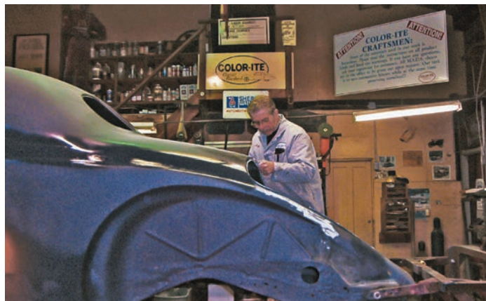
Choć ten Lincoln Zephyr z 1937 roku został wyprodukowany na linii montażowej, jego renowacja odbywa się w zakładzie wykorzystującym proces produkcji jednostkowej, w którym pracownicy o szerokich kwalifikacjach posługują się narzędziami ogólnego przeznaczenia
