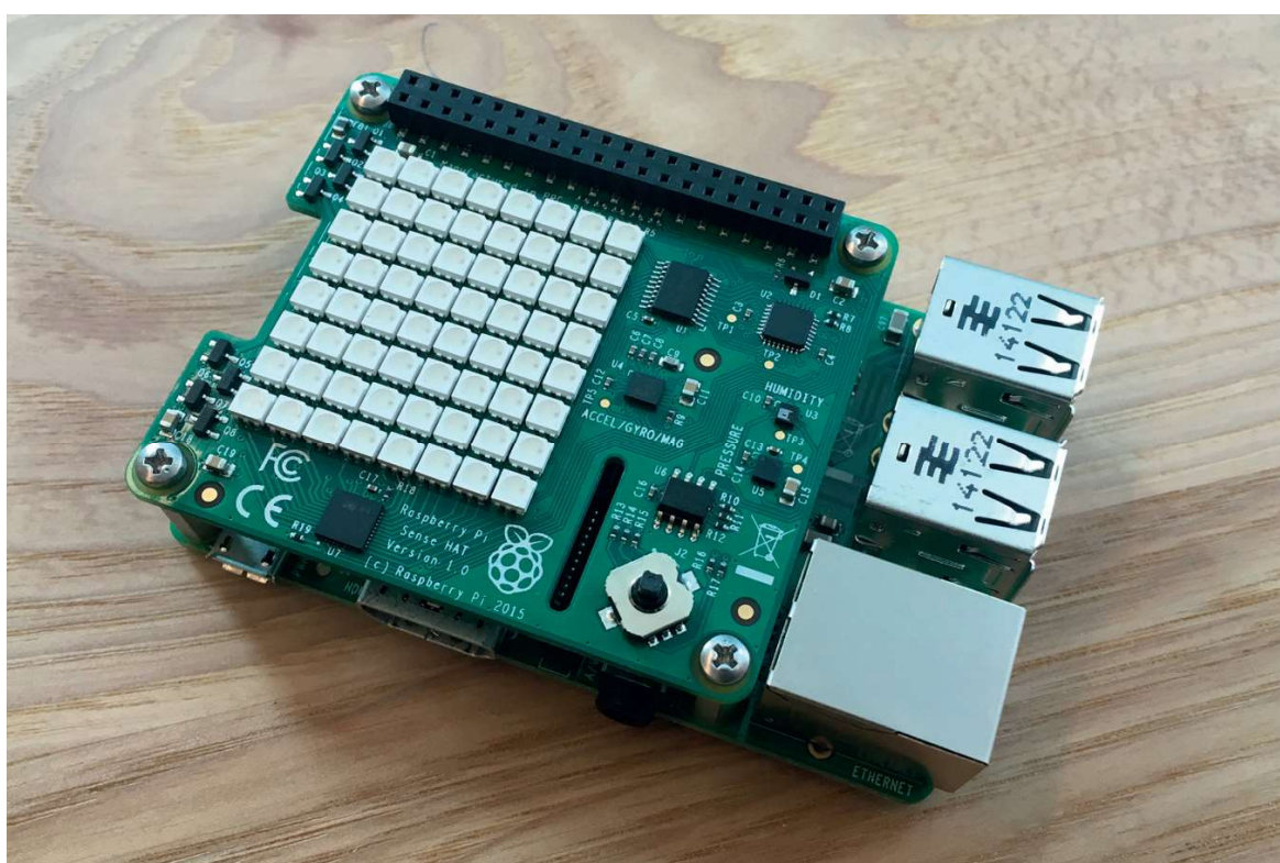
Rysunek 1-5 Karta rozszerzeń Sense HAT zawiera macierz LED, komplet czujników i wejście joysticka. Została zaprojektowana dla płytek Raspberry Pi, które były wysyłane do Międzynarodowej stacji kosmicznej.
