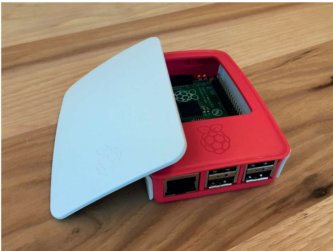
Rysunek 1-7 W oficjalnej obudowie Raspberry Pi można usunąć górę i boki, aby uzyskać dostęp do różnych części płytki.
