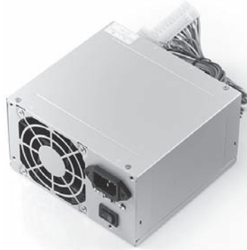
RYSUNEK 5.7. Zasilacz komputerowy typu ATX (zdjęcie publikowane za pozwoleniem SparkFun Electronics)
