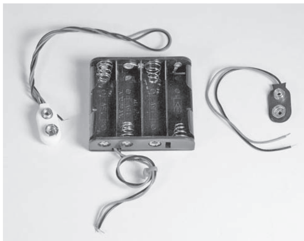
RYСУNEK 5.6. Zaciski (po lewej i prawej stronie) oraz uchwyty (środek) na baterie
