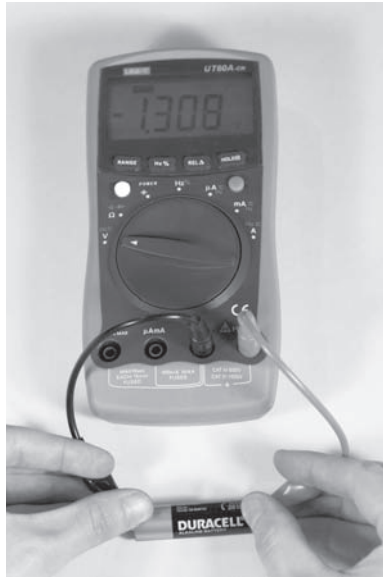
RYSUNEK 5.1. Odczyt napięcia za pomocą miernika cyfrowego
