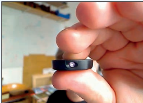
▲ Rysunek 6.3. Aparat fotograficzny jest przydatny podczas rozwiązywania problemów z projektami IR
