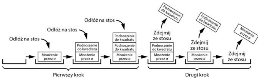
Rysunek 2.4. Zawartość stosu opStack podczas wywołania funkcji exponentWithPowerRule(6, 5)
