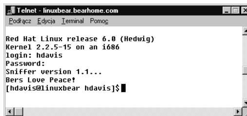
Rysunek 13.6. Po połączeniu się z hostem zostaniesz zapytany o identyfikator użytkownika i hasło.
