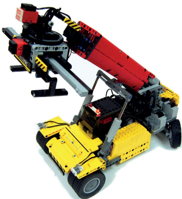
Rysunek 1-5: Mój model podnośnika kontenerowego (reach stacker) ma tylną oś (po prawej) ze szczególnie dużym kątem skrętu, podobnie jak prawdziwy pojazd. Podnośniki te są przeznaczone do ustawiania kontenerów w obszarach załadunkowych portów i muszą manewrować na ograniczonej powierzchni.
