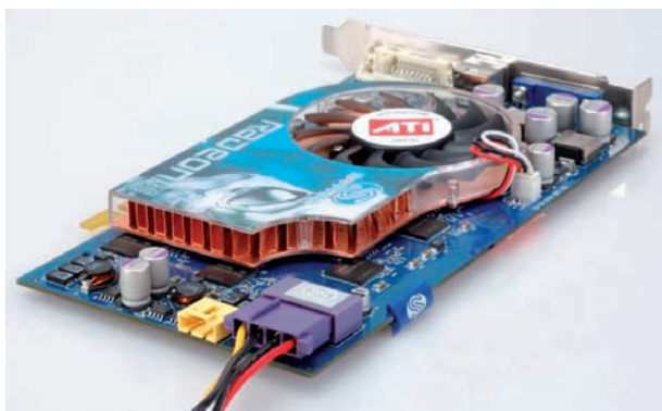
Rysunek 7.18. Podłączenie zasilania karty
