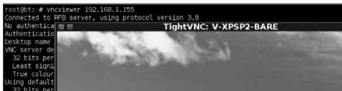
Rysunek 4.18. Zastosowanie narzędzia vncviewer do połączenia się z VNC niewymagającym uwierzytelniania
