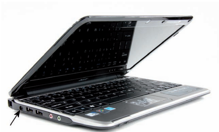
Rysunek 4.3. Podłączanie zasilania — etap pierwszy
