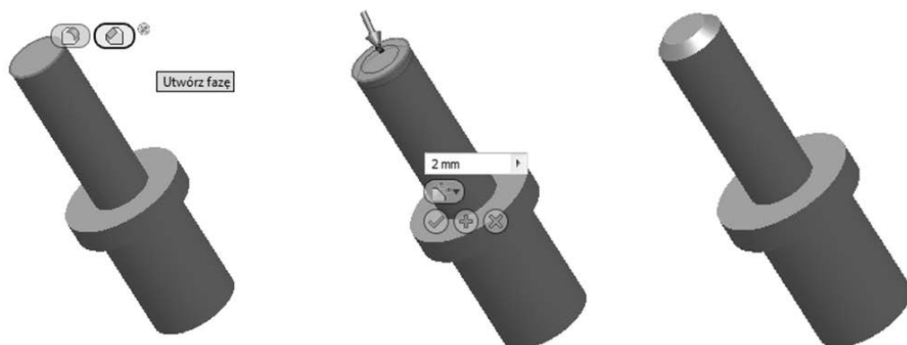
Rysunek 4.12. Ścięcie krawędzi na modelu bryłowym wałka
