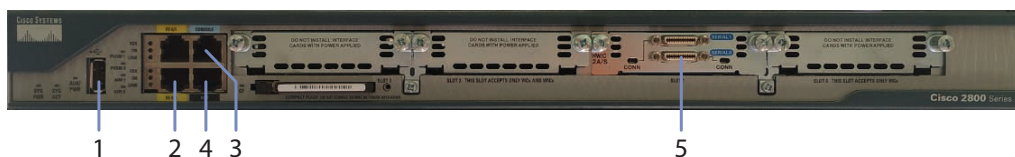
Rysunek 11.1. Panel z różnymi interfejsami routera: 1 — port USB, 2 — interfejsy Fast Ethernet, 3 — port konsoli, 4 — port AUX, 5 — interfejsy szeregowy
