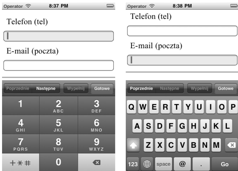
Rysunek 4.8. Osoby korzystające z urządzeń przenośnych przy wypełnianiu formularza są na ogół pozbawione luksusu, jakim jest pełna klawiatura. iPod ułatwia życie takim użytkownikom strony, dopasowując wirtualną klawiaturę do spodziewanego typu danych. Pole tekstowe wymagające podania numeru telefonu wywołą klawiaturę numeryczną (po lewej), podczas pole z adresem e-mail spowoduje pojawienie się klawiatury z dedykowanym przyciskiem @ i mniejszym klawiszem spacji (po prawej)
