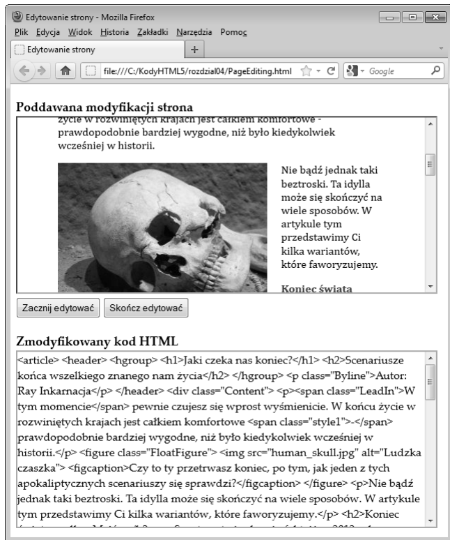
Rysunek 4.18. Na tej stronie umieszczono dwa pola. W pierwszym polu, utworzonym przez element <iframe> , widać omawianą w rozdziale 2. apokaliptyczną stronę. Drugie pole jest zwykłym elementem <div> , który wyświetla kod dokumentu HTML po tym, jak został zmodyfikowany. Dwa przyciski pośrodku strony służą do przełączania komponentu <iframe> w tryb projektowania i z powrotem w tryb normalny
