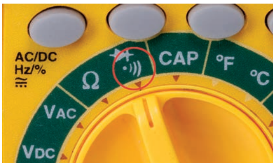
Rysunek 6.32. Symbol testu ciągłości obwodu na innym mierniku
