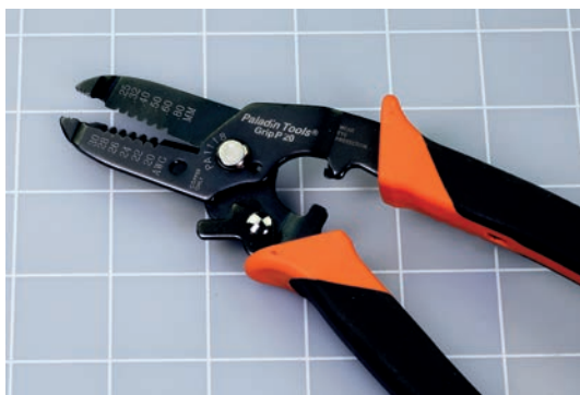
Rysunek 6.6. Szczypce do zdejmowania izolacji z drutu
