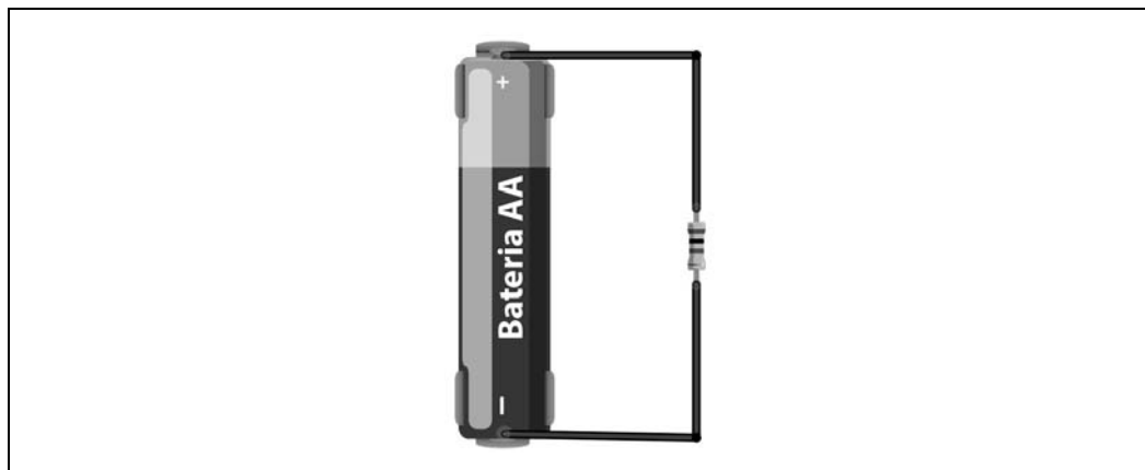
Rysunek 1.4. Bateria i rezystor
