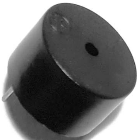
Rysunek 1.21. Przetwornik piezoelektryczny, podobnie jak dioda LED, powinien być odpowiednio spolaryzowany, aby generować dźwięk. Wyprowadzenie oznaczone plusem musi być podłączone do punktu o wyższym potencjale
