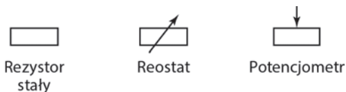
Rysunek 5.8. Symbole do oznaczania rezystorów
