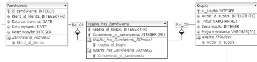
Rysunek 1.21. Definiowanie połączenia „wiele do wielu”
