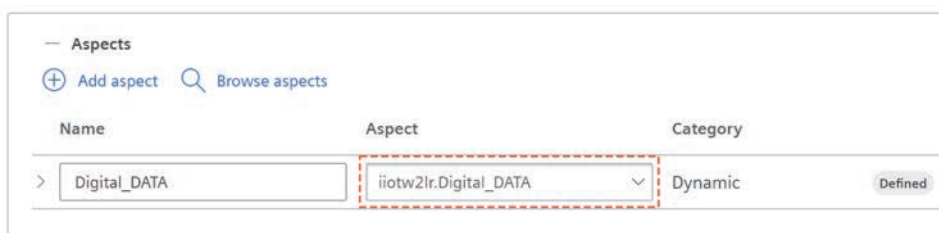
RYСУNEK 7.8. Wybór aspektu w ramach nowo tworzonego assetu odpowiedzialnego za reprezentację sterownika PLC w chmurze
