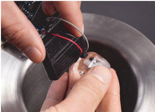
Rysunek 3.19. Testowanie czujnika LM35 za pomocą kostek lodu
