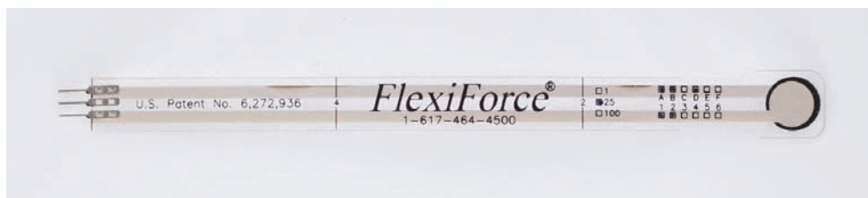
Rysunek 3.14. Rezystancyjny czujnik siły nacisku mierzy wywieraną na niego siłę
