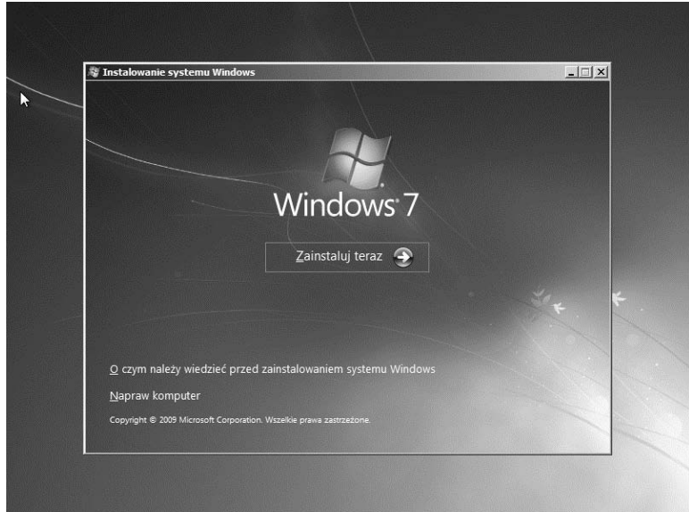
Rysunek 3.26. Kliknij pozycję Napraw komputer, aby rozpocząć procedurę przywracania kopii systemu
