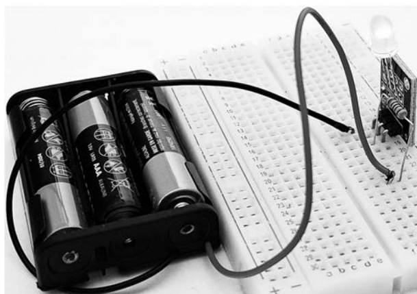
Rysunek w.4. Prąd płynie z baterii, przez rezystor i dopiero potem do diody LED
