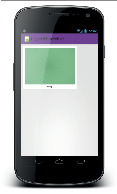
Rysunek 14.10. Przykład wielowarstwowego obiektu drawable zdefiniowanego za pomocą elementu layer-list
