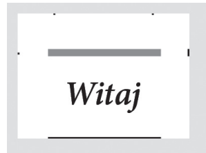
Rysunek 14.6. Efekt wyświetlenia przykładowego obrazu na podstawie definicji 9-patch po zmniejszeniu
