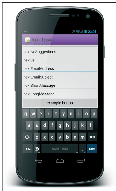
Rysunek 10.5. Zaznaczone pole tekstowe adresu poczty elektronicznej (z odpowiednio ustawionym typem danych wejściowych) zapewnia użytkownikom łatwy dostęp do znaków specjalnych potrzebnych podczas wpisywania adresu
